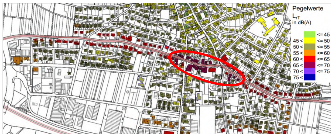
Abbildung 9: Hauptbelastungsbereich K 1866 Grunbach
